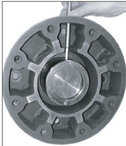
图 4.12 紧固驱动轴套锁定螺栓
