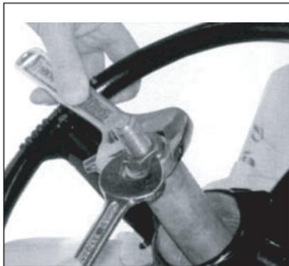
图 5.6 下止挡和两个扳手
