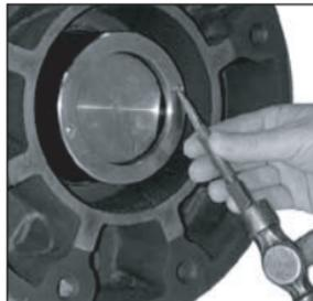
图 4.6 拆卸轴套挡圈
