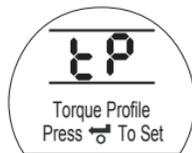
按 键将最后一次测量的关 - 开和开 - 关的“参考”力矩分布图存储至数据记录器中。
