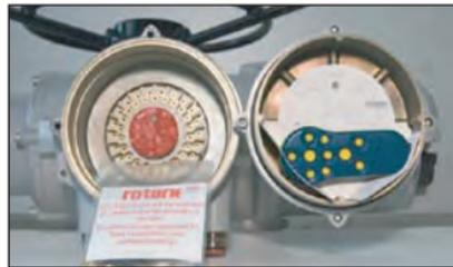
图 6.2 执行器带有Rotork增强型设定器
