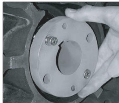
图 4.14 B3/B4型轴套的位置
