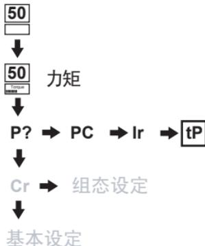
每台执行器在供货时并没有存储力矩参考分布图。存储分布图需将执行器在正常工艺条件下运行一个行程。
